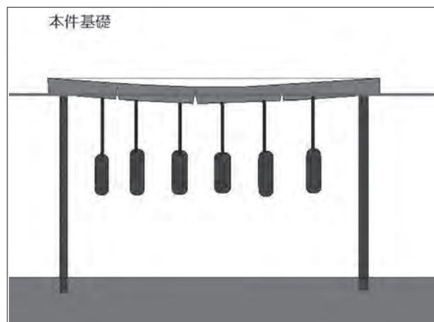
支持杭 (16~18メートル) とし、その他を柱状地盤改良 (4.5メートル) にて支持する方法を採用。その結果、柱状地盤改良がいわば建物中央部にぶら下げられたオモリの役割を果たし、建物を中央に向かって引きずりこみ、沈下と建物破壊を進行させた (下図参照)。2002年12月時点ですでに建物中央付近が端部に比して最大40ミリも沈下しており、その後も沈下と破壊が進行した。
