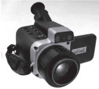
調査装置（サーモグラフィー R300型）
